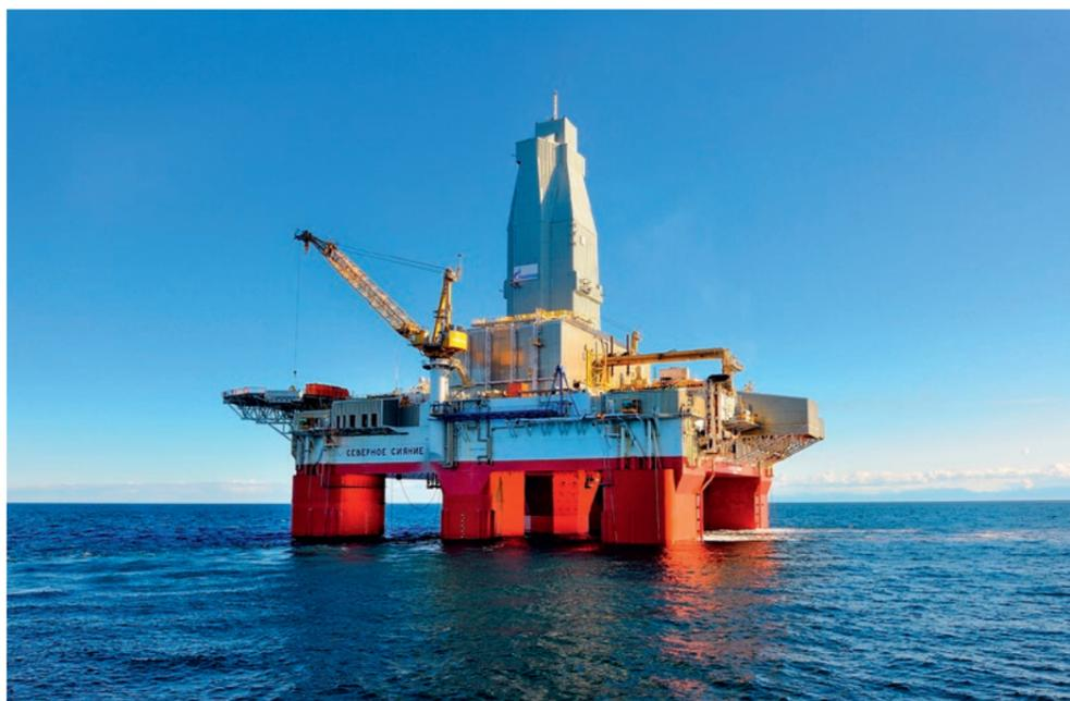
Полупогруженная буровая установка «Северное сияние», Южно-Киринское месторождение
