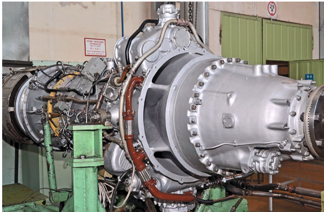
Двигатель АИ-20 после ремонта
