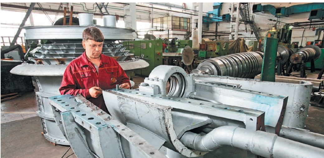
Ремонт корпусов ГТК-10И
