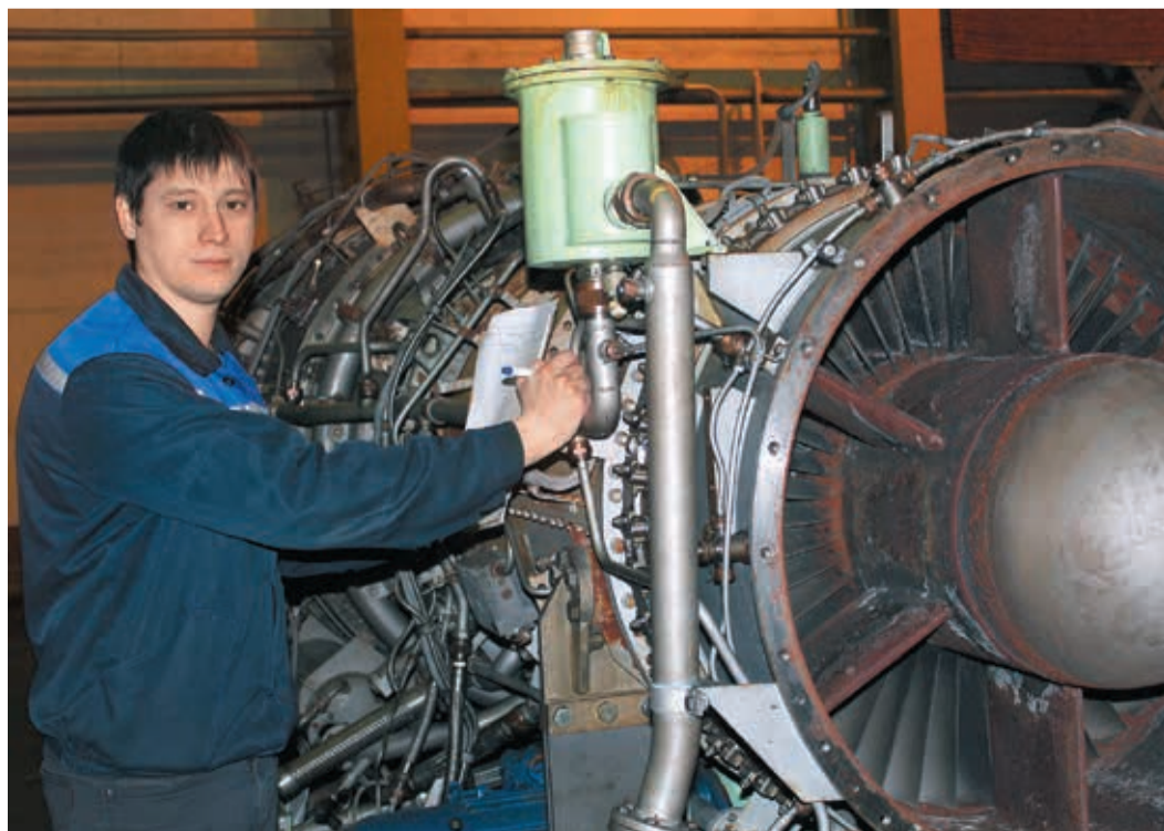
А.Н. Ковалев заполняет ведомость осмотра поступившего на капитальный ремонт двигателя ДГ90
