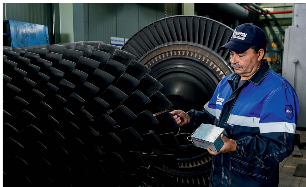
Дефектоскопия методом неразрушающего контроля лопаточного аппарата осевого компрессора
