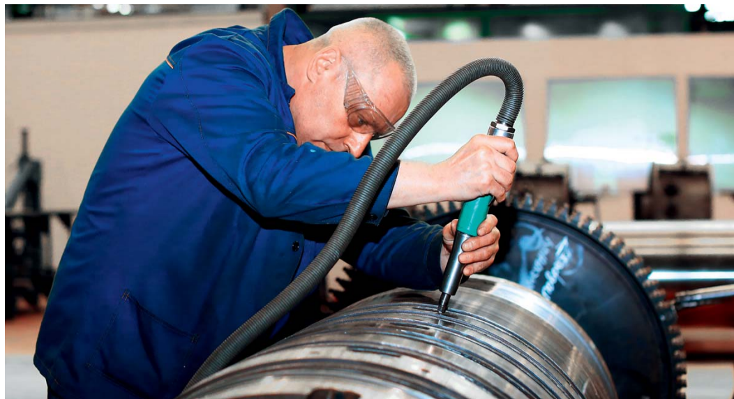
Ремонт ротора турбокомпрессора
