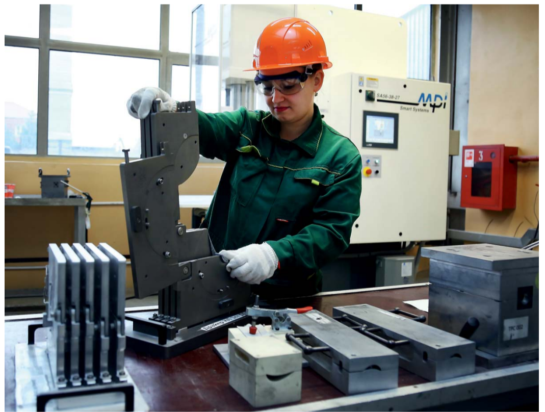
Проверка геометрии изготовленных стержней
