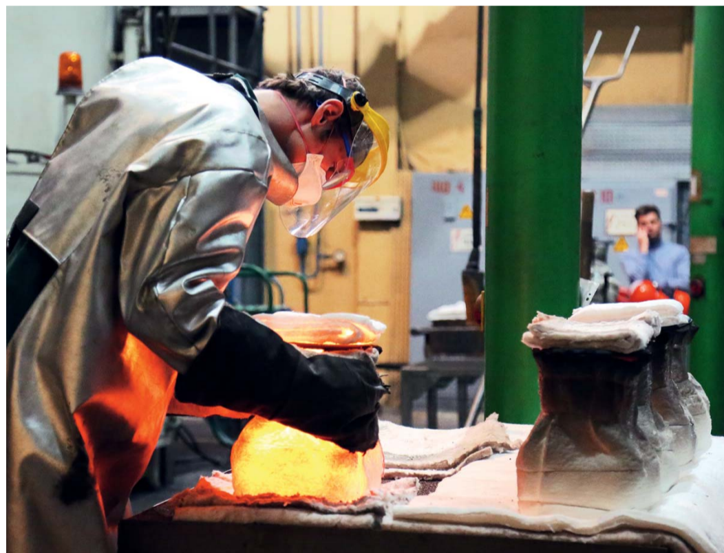
Установка залитого блока на стол для охлаждения
